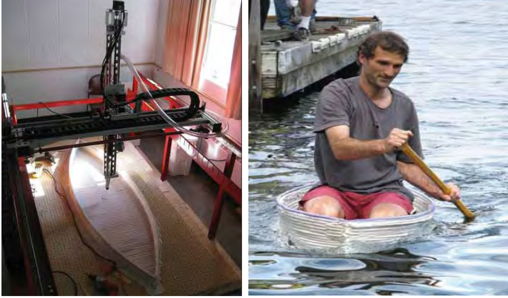
Şekil 5. Bay Rogge ve arkadaşlarının 3D Baskı ile ürettikleri tekne [3]
