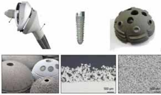
Şekil 5. Plazma sprey prosesi ile üretilmiş Hap kaplamalar ve mikroyapı görüntüsü (Ti6Al4V alaşım üzerine)
