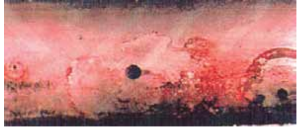
Şekil 5: MIC bağlantılı çukur korozyonu neticesi oluşmuş çelik boru delinmeleri
